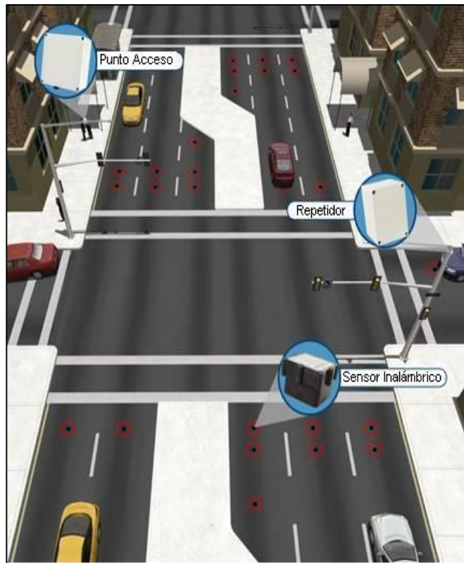
Figura 2. 31 Aplicación en intersección
